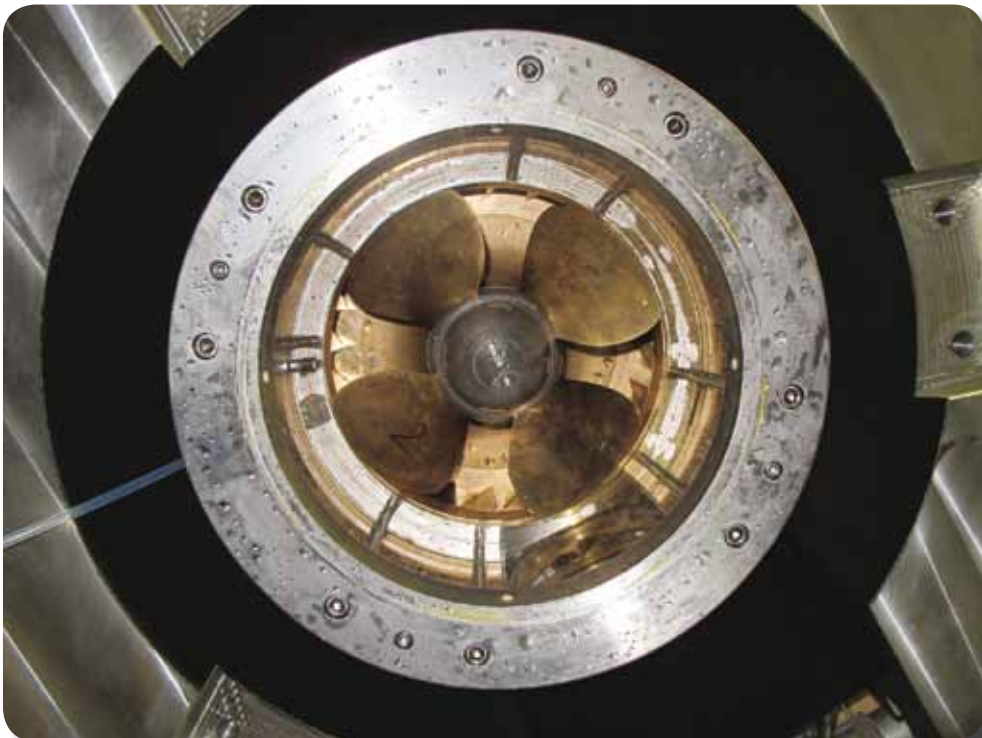
Retrofit: Blick auf Modellauftrad und Nabe im Teststand
